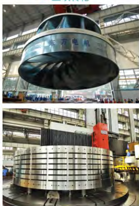
▲ 巴西杰瑞转子支架在22米立车上加工
