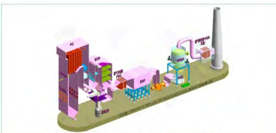
煤粉炉(PC)协同控制超净排放技术
