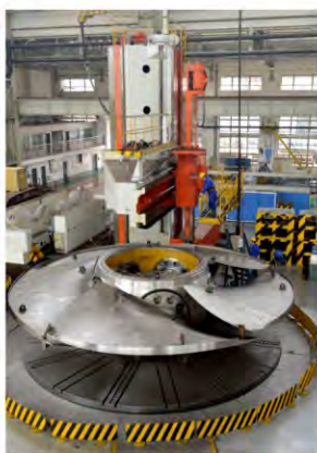
▲ 安谷190MW轴流转桨式水轮机转轮加工
